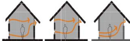
Gambar 1. Mempercepat Aliran Udara dengan Pergeseran Lubang Masuk Sumber: Frick & Suskiyanto, 2007
