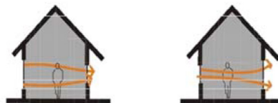
Gambar 3. Mempercepat Aliran Udara dengan Memperbesar Lubang Masuk atau Keluar Sumber: Frick & Suskiyanto, 2007
